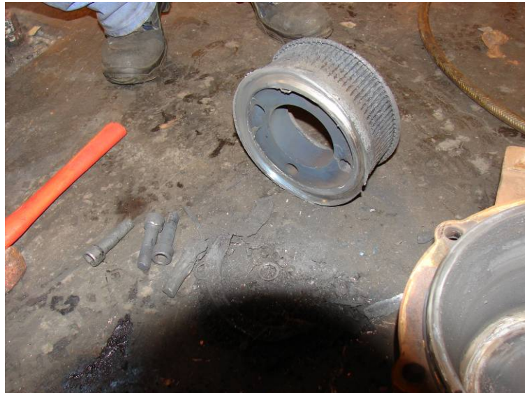
Foto: Pol-hjul og de 4 knækkede unbrakoskruer
