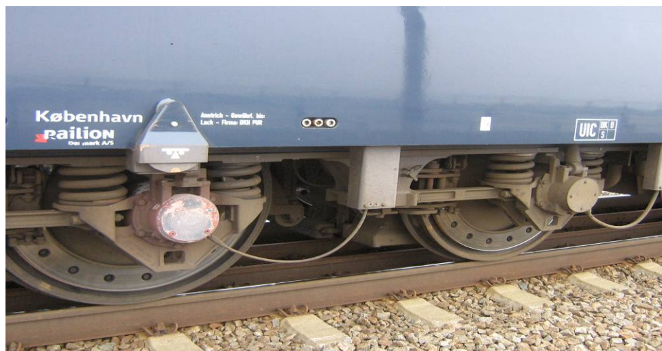
Foto: Til venstre ses det afbrændte akselleje
