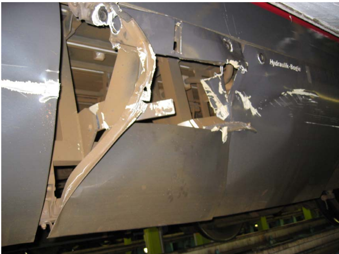
Figur 4. Nogle af beskadigelserne på S-toget
