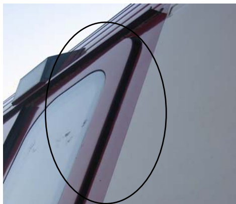
Foto 6: Dørsæt i højreside i køreretningen på MFB 5233 Derudover blev det konstateret, at et sikringsbeslag var flyttet fra de oprindelige skruehuller, hvilket vurderes til efterfølgende, at have haft indflydelse for låsepalens indgreb. (se foto 7)
