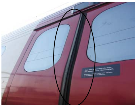
Foto 5: Dørsæt i højre side i køreretningen på MFB 5233 dørblad overlapper
