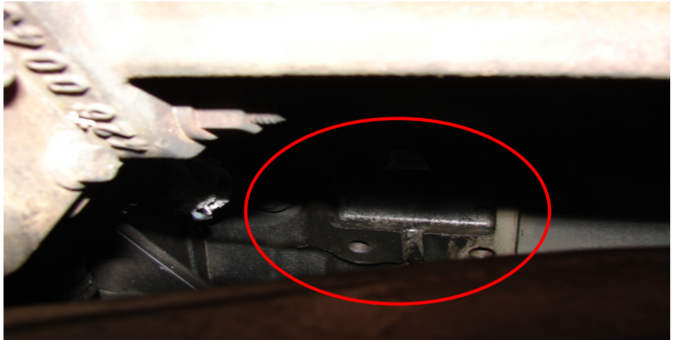
Foto 7: Spor af lækage af dieselolie på motorblok
