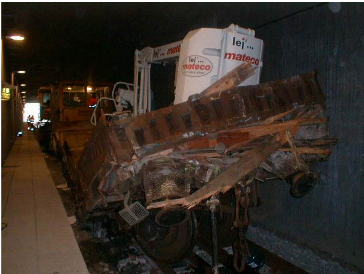
Figur 6: Ks vognen foran arbejdskøretøjet efter kollisionen (Banestyrelsen) er gennemgået i afsnit 3.3.3.
