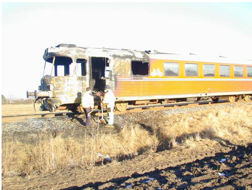
Figur 1: YM 58 med det udbrændte førerrum
