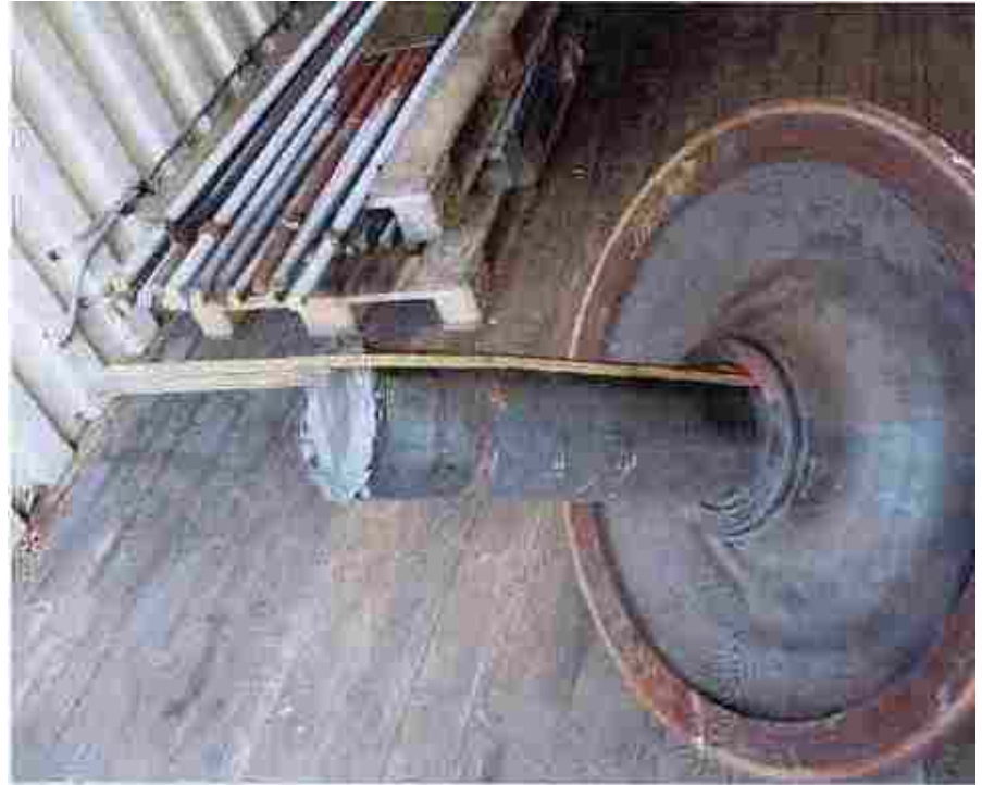
Figur 1: Knækket godsvognsaksel. Bruddet er sket 55 cm fra hjulnavet.
