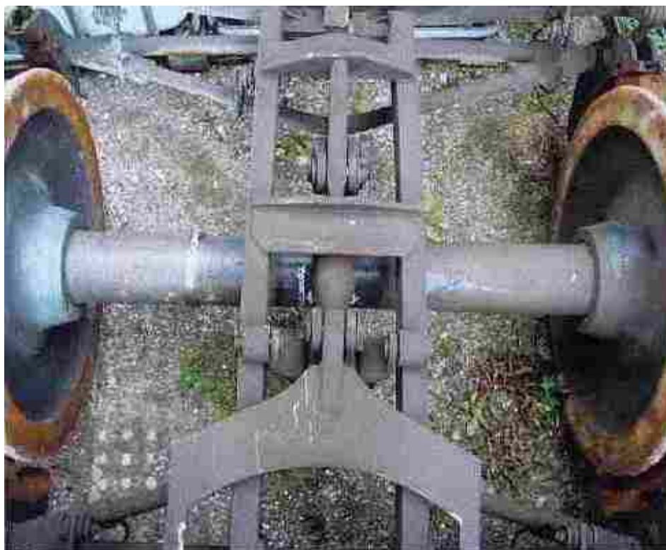
Figur 5: Foto af ubeskadigede aksel på den havarede bogie.
