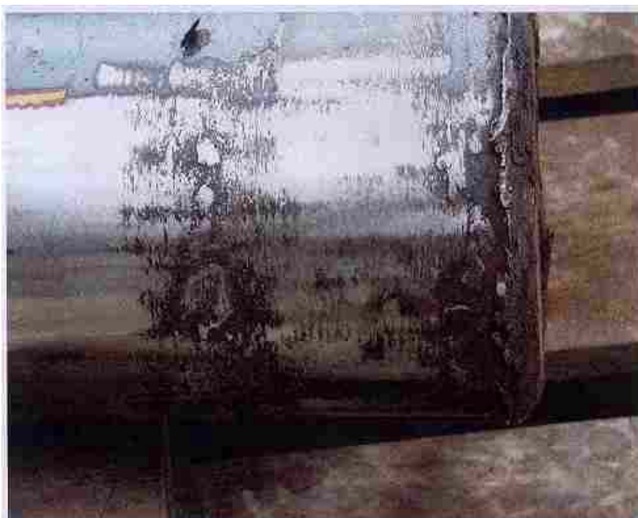
Figur 4: Nærbillede af slidspor med fastsvejet fremmedmateriale (friktionssvejst)
