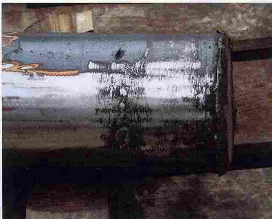
Figur 3: Foto af akseloverfladen efter delvis fjernelse af malingen. Bemærk at grundmalingen (rødbrun-gul-rødbrun) har været fjernet i området op til brudfladen, og at der er kraftige slidspor med fastsvejet fremmedmateriale under den blågrå dækmaling.
