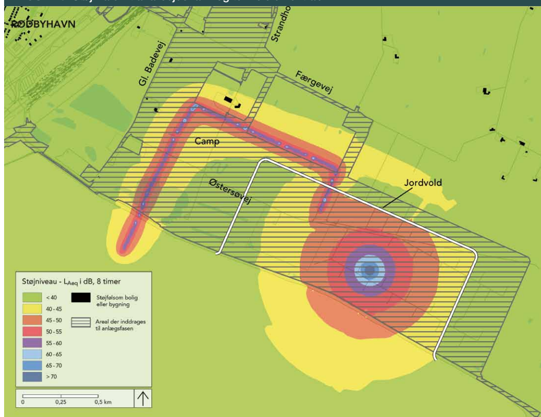
FIGUR 10 Støj fra drift af arbejdshavn og tunnelementfabrik
