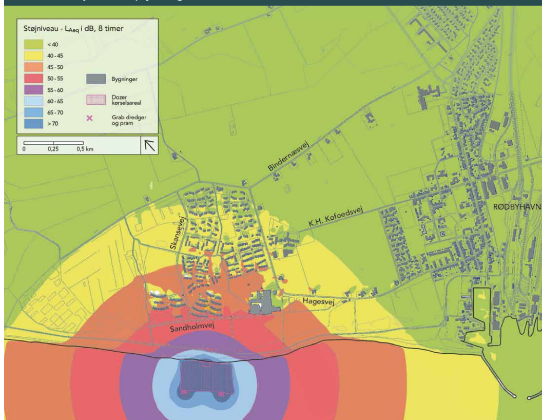
FIGUR 5 Støj fra landopfyldning ud for Lalandia
