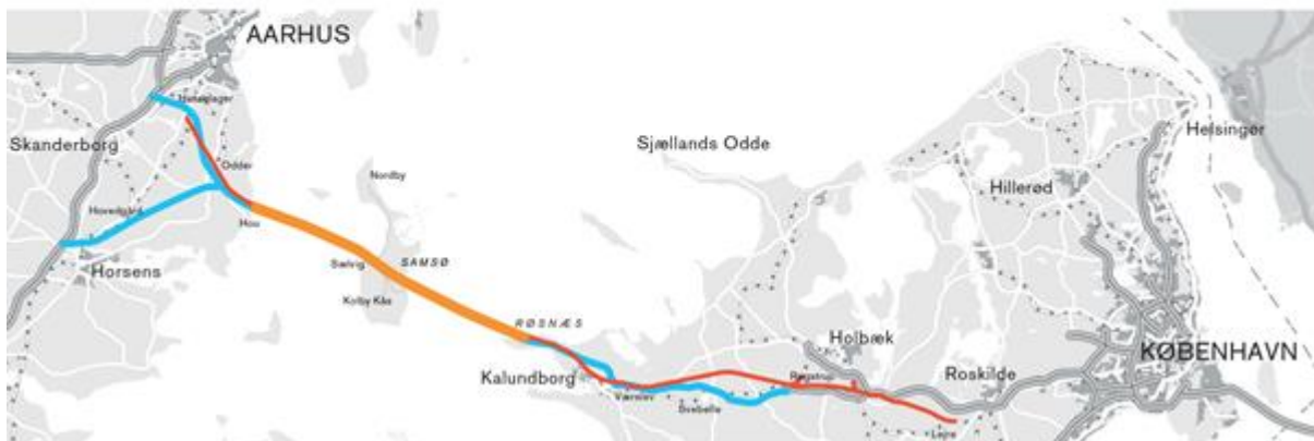
Figur 3.3 Oversigt over eksisterende og ny infrastruktur/linjeføring for en fast Kattegatforbindelse, som er forudsat i trafikmodelberegningerne i den strategiske analyse.
