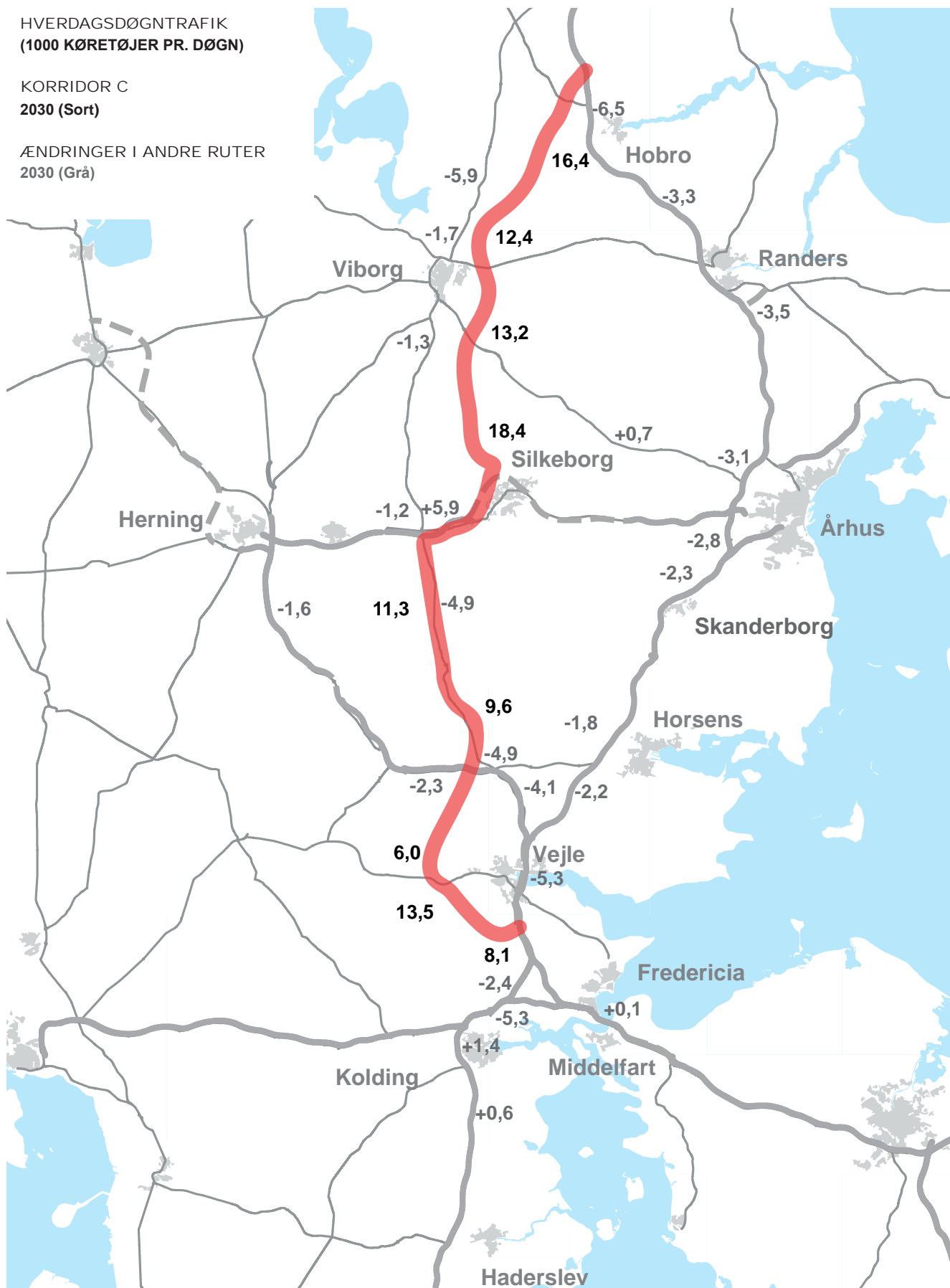
FIGUR 7.4 Hverdagsdøgntrafikken på Midtjysk Motorvej i Korridor C og ændringer i antal biler på de overordnede veje i Jylland i 2030 (antal biler i 1.000).
