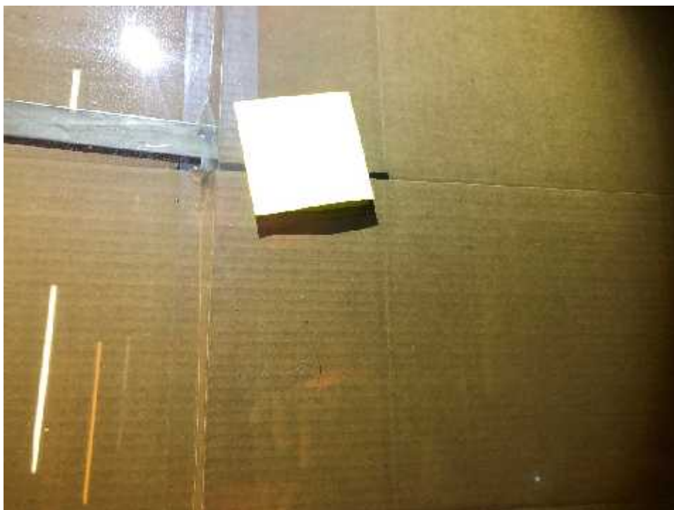
IMG2744/2745: Omfang af ridser (<25% af ruden) samt ridsebredde og placering er indenfor acceptkriterier. Derfor kategoriseres som Æ.
