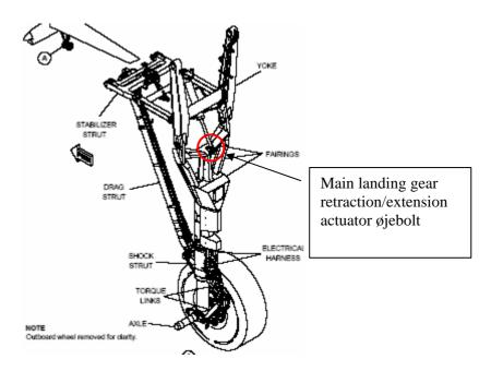
Landingsstellets aktuator, øjebolt og afstivningsstabilisator blev demonteret fra luftfartøjet for videre undersøgelse på et laboratorium.
