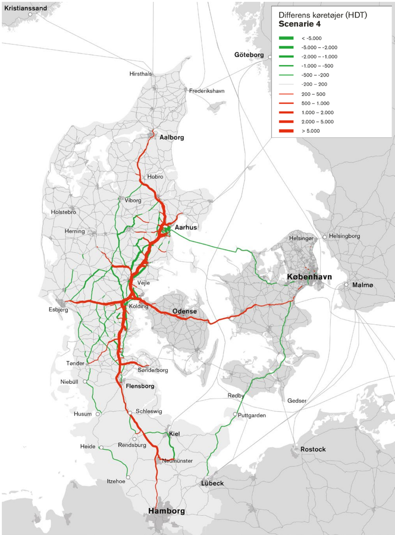
Kort 4.9: Stigning (rød) og fald (grøn) i trafikken ved anlæg af scenarie 4 sammenlignet med en situation uden en udbygning af Jyllandskorridoren.
