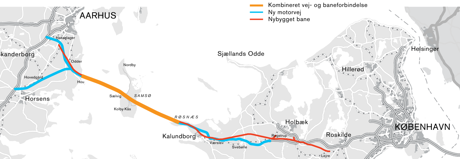
Figur 1.2 Overordnet skitsering af linjeføringen for en fast Kattegatforbindelse i de gennemførte beregninger.
