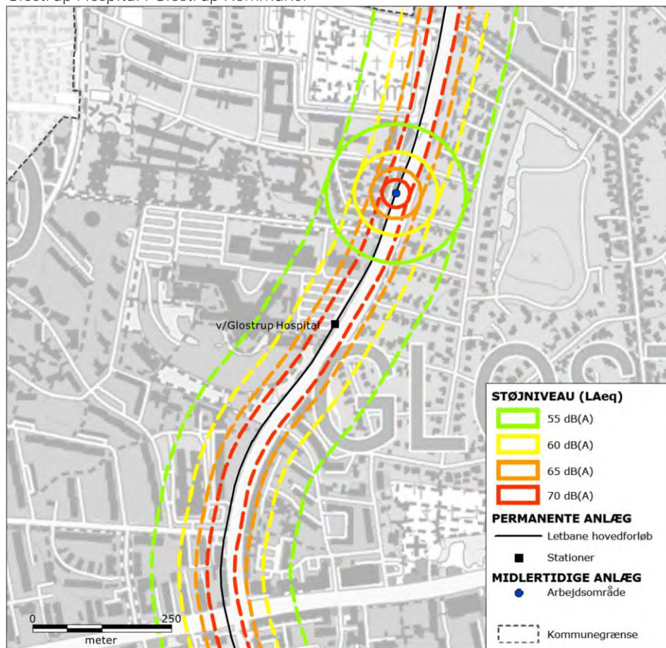
Bilag 3.c-18 | Støjkort for ombygning af vejanlæg og etablering af køreledningsanlæg ved Glostrup Hospital i Glostrup Kommune.
