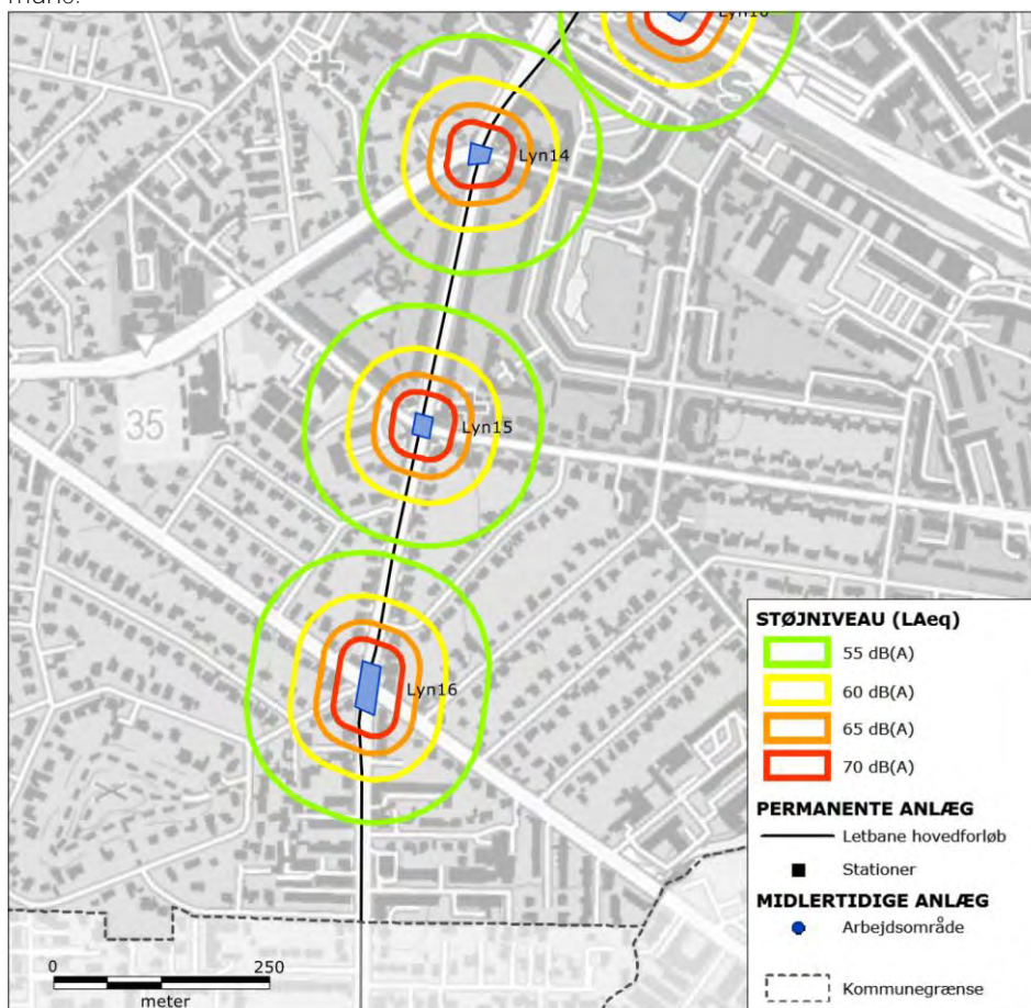
Bilag 3.b-3 | Støjkort for større krydsombygning i sydlig del af Lyngby-Taarbæk Kommune.
